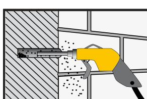
Izbušena rupa mora se očistiti pumpom za puhanje ili komprimiranim zrakom, počevši od dna rupe. (najmanje 2x) sve dok povrtni zrak nije slobodan od prašine.
