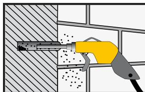
Izbušena rupa mora se očistiti pumpom za puhanje ili komprimiranim zrakom, počevši od dna rupe. (najmanje 2x) sve dok povrtni zrak nije slobodan od prašine.
