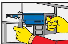
Izbušite rupu električnom bušilicom do potrebnog promjera i dubine. Promjer rupe za bušenje mora biti u skladu s veličinom sidara.
