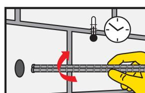
Umetnite sidro rotirajućim gibanjem u ispunjeni otvor za bušenje. Iz rupe mora izaći nešto ljepila. Važno: sidro se mora postaviti unutar otvorenog vremena.
