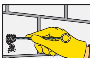
Izbušena rupa mora se temeljito očistiti posebnom čeličnom četkom (četkati najmanje 2x). Promjer četke mora biti veći od promjera rupe za bušenje.
