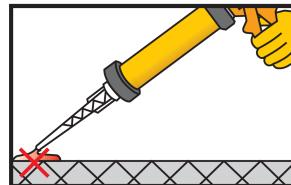
Pumpati cca. dva puta dok oba dijela ne počnu izlaziti jednoliko. Ne koristite ovaj materijal. Otpustite pritisak pištolja i očistite otvor spremnika krpom.
