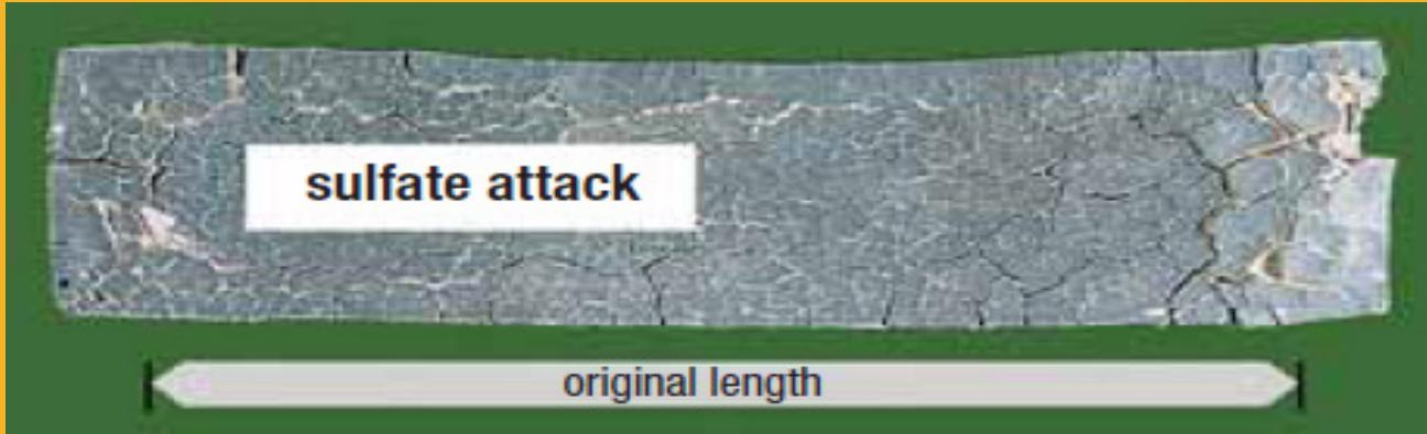
Sulfatna agresija izazvana sulfatima otopljenim u vodi. Reakcijom s stvrdnutom cementnom matricom , inducirano je povećanje volumena koje oštećuje strukturu
