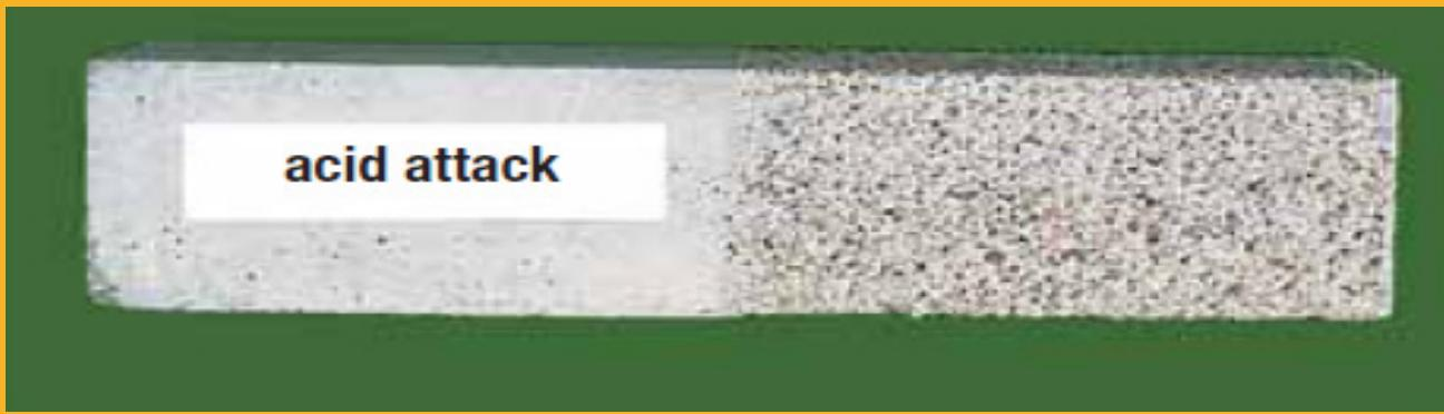
Kiselinski napadi koji otapaju kalcijeve spojeve iz stvrdnute cementne matrice mogu biti uzrokovani kiselinama, topivim solima, biljnim ili životinjskim mastima i uljima. Propadanje betona obično se odvija vrlo sporo.
