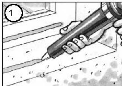
Nanijeti **SikaBond-TF plus** ljepilo na nosivu konstrukciju pomoću pištolja (promjer plastičnog nastavka cca. 8 mm).
