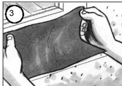
Lagano saviti **SikaMembran** traku i položiti je u spoj bez nepotrebnog naprezanja. Pritisnuti membranu u ljepilo. Preklapanje rubnih spojeva trake: 5-10 cm.
