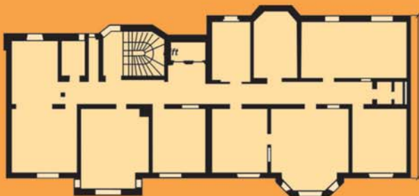
Postojeća nosiva konstrukcija prije adaptacije, drugi kat
