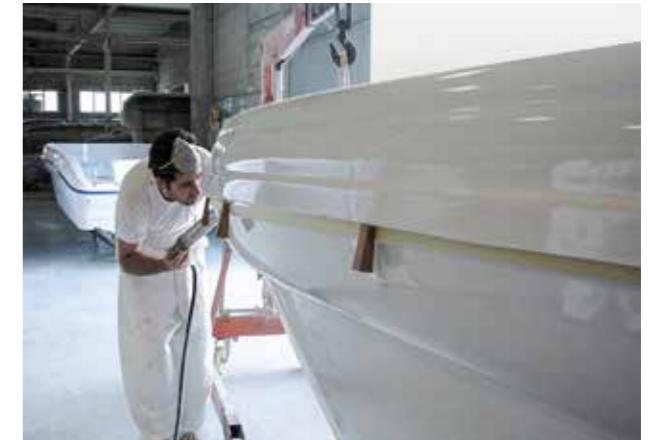
Za optimalan rezultat brtvilo je potrebno ugrađivati odgovarajućom opremom, tj. pištoljem za nanošenje. Sikaflex®-591 moguće je premazati većinom uobičajenih boja prikladnih za morsko okruženje. Kompatibilan je s obojenim metalima i dobro priana na podloge koje se često koriste u brodogradnji.
