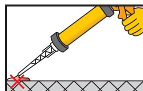
Pumpati cca. dva puta dok oba dijela ne počnu izlaziti jednoliko. Ne koristite ovaj materijal. Otputujte pritisak pištolja i očistite otvor spremnika krpom.
