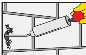
Izbušena rupa mora se očistiti pumpom za puhanje ili komprimiranim zrakom, počevši od dna ruke. (najmanje 2x)
