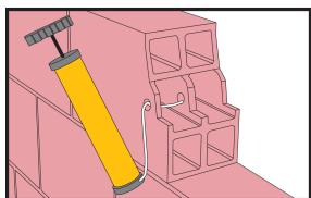
Izbušena rupa mora se očistiti nakon svakog koraka čišćenja pumpom za puhanje ili komprimiranim zrakom, počevši od dna rupe (pumpati najmanje 1x).
