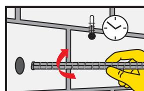
Umetnjite sidro rotirajućim gibanjem u ispunjeni otvor za bušenje. Iz rupe mora izaći nešto ljepila.
