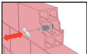
Izbušena rupa mora se temeljito očistiti okruglom četkom (četkati najmanje 1x). Promjer četke mora biti veći od promjera rupe za bušenje.
