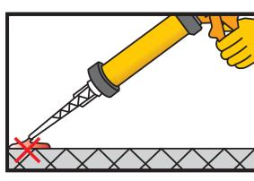
Pumpati cca. dva puta dok oba dijela ne počnu izlaziti jednoliko. Ne koristite ovaj materijal. Otputujte pritisak pištolja i očistite otvor spremnika krpom.
