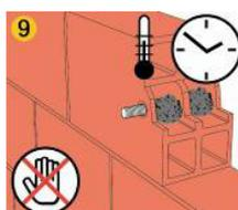
Tijekom vremena očvršćavanja sidro se ne smije pomicati ili opteretiti. Odmah isprati alate Colma Čistačem.
