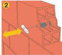
Rupu treba dobro očistiti okruglom četkom (min. 1x).
