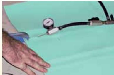
Fizičko testiranje dvostrukog varu i središnje praznine zrakom pod pritiskom
